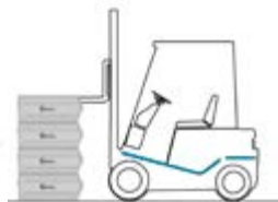
Aufnahmesystem mit Gabelstapler
