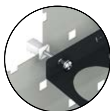
BEFESTIGUNG AUF LOCHPLATTEN
