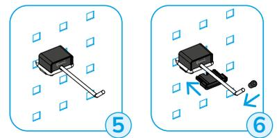
La butée de sécurité bloque le crochet en position horizontale et évite qu'il ne bouge durant les opérations de préhension/dépôt des outils.
