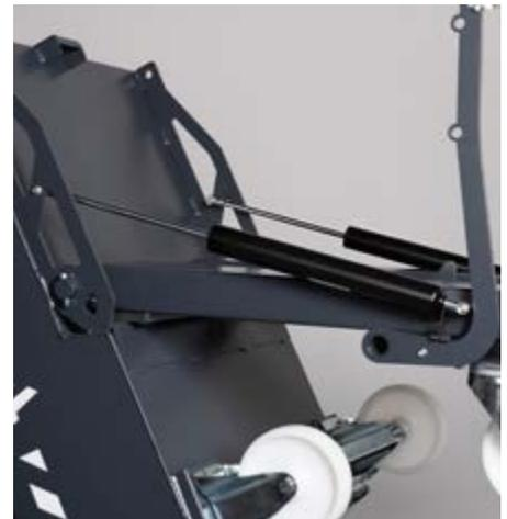
HYDRAULIKZYLINDER FÜR KIPPBEHÄLTER
