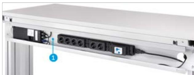
Die Traverse der Werkbank verfügt über Aussparungen für die Anbringung von Steckdosen und Schutzschaltern Iron Team Electric. Je nach gewählter Größe variiert die Anzahl der Aussparungen. Die verschiedenen Komponenten können entweder auf der Rückseite oder auf der Vorderseite der Traverse installiert werden.
