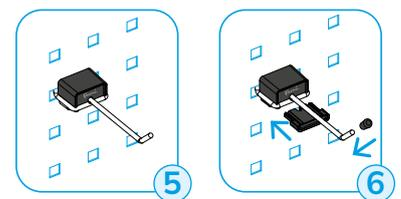
Die Sicherheitsperre arretiert den Haken in horizontaler Position und verhindert, dass er sich bei der Entnahme/Ablage von Werkzeugen bewegt.
