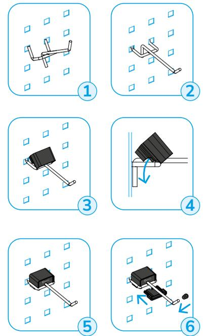
Die Sicherheitssperre arretiert den Haken in horizontaler Position und verhindert, dass er sich bei der Entnahme/Ablage von Werkzeugen bewegt.
