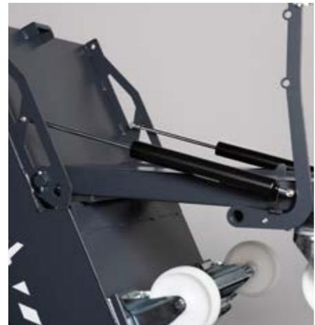
HYDRAULIKZYLINDER FÜR KIPPBEHÄLTER
